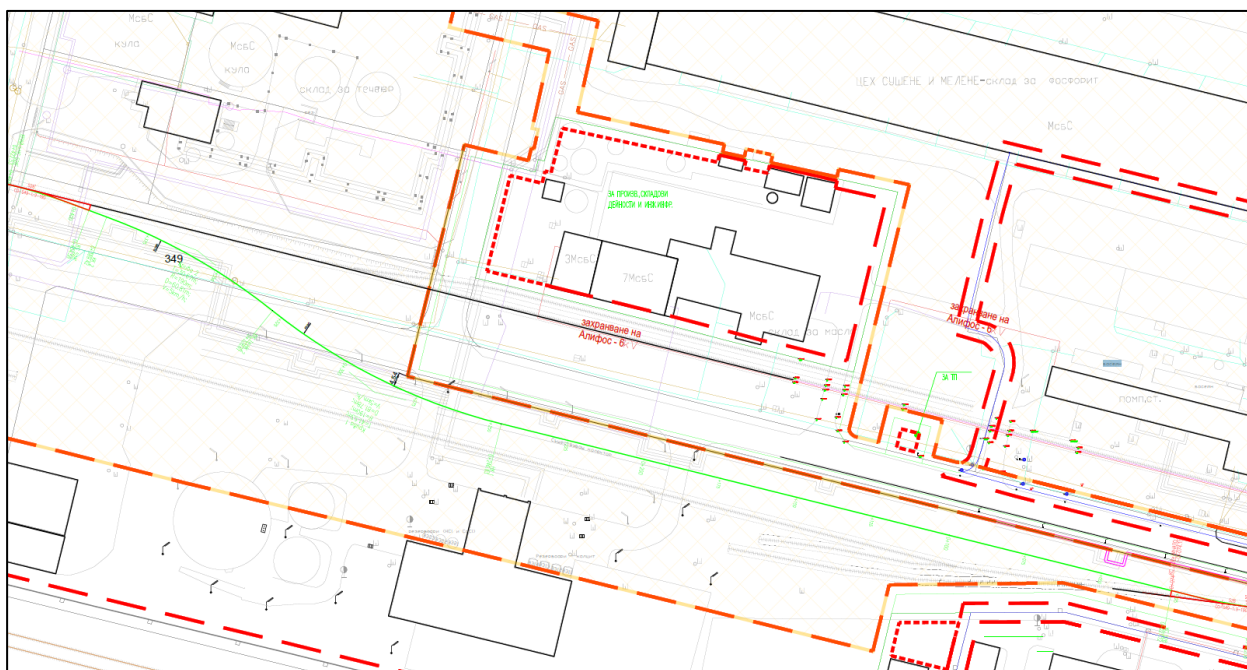
Фиг. 2. Ситуация S-връзка между коловози №№ 9 и 8
